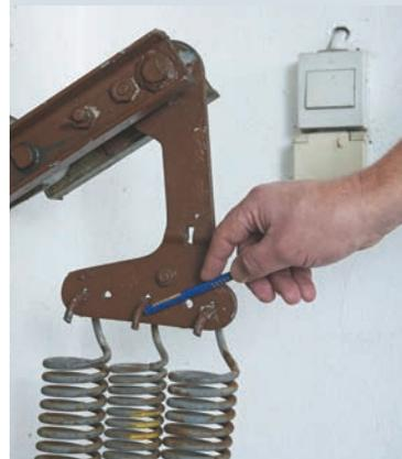
Die Sicherheit hängt am seidenen Faden: Kein Schutz gegen das Wegspringen der Federn.
